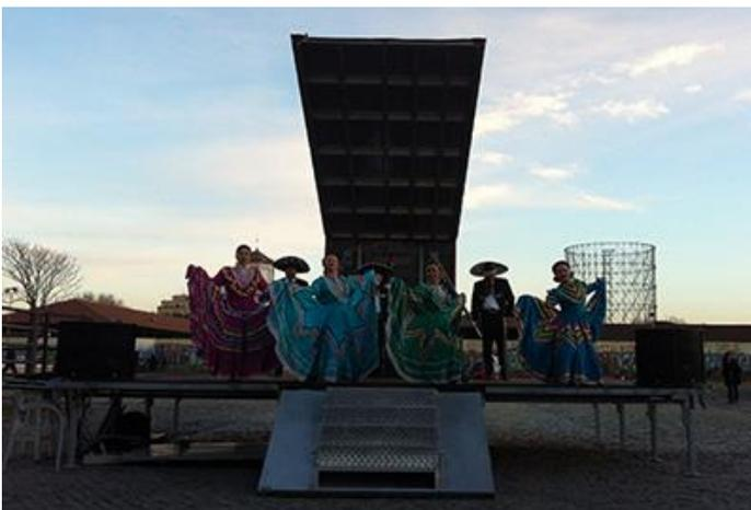
2. Apertura completa con tutte e due le pareti in piano e il soffitto sollevato fino a 45° rispetto alla cabina di guida, la superficie calpestabile in questa modalità è di circa 30 metri quadrati (4.40 di profondità per 7.00 di larghezza).
